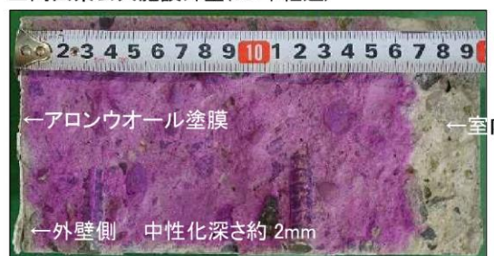
■岡山県公共施設外壁(39年経過)で採取したコア 【引用資料】アロンウオール テクニカルレポート No.43
